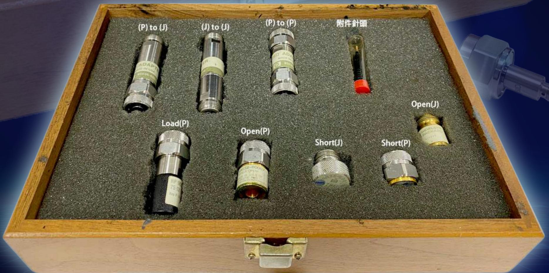
二手 HP/Agilent/85036B Type N 75Ω Calibration Kit
